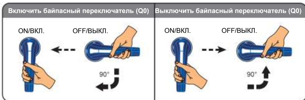
Рисунок 2-5: Включение/ выключение байпаса (Q0)
