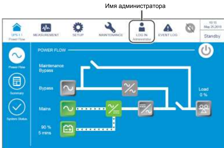
Рисунок 6-60: Экран режима ожидания и имя администратора
