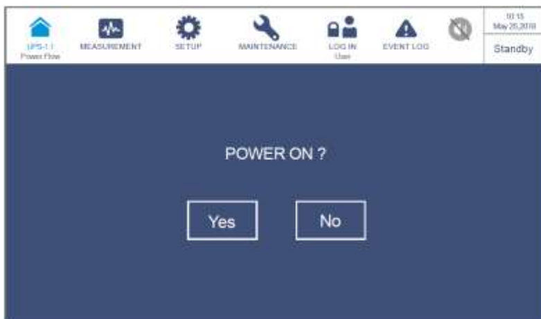
Рисунок 6-8: Экран с запросом о включении
