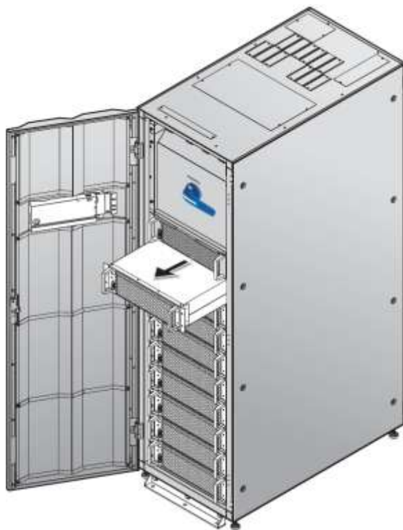
Рисунок 5-45: Демонтаж силового модуля
