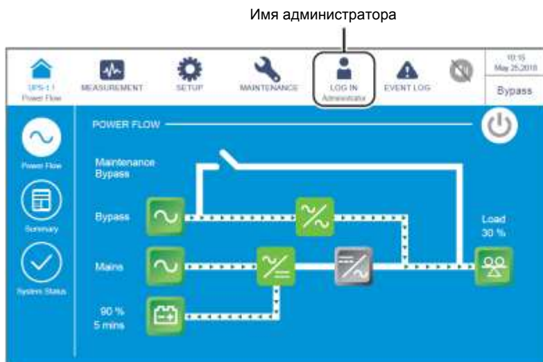
Рисунок 6-55: Экран байпасного режима и имя администратора
