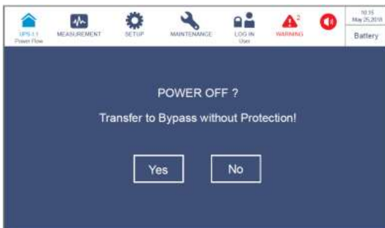
Рисунок 6-49: Экран с запросом об отключении
