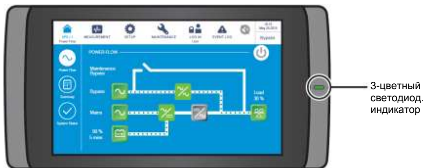
Рисунок 2-11: Расположение трехцветного светодиодного индикатора
