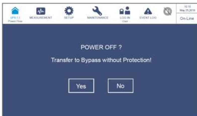
Рисунок 6-15: Экран с запросом об отключении
