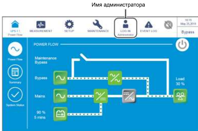
Рисунок 6-65: Экран байпасного режима и имя администратора
