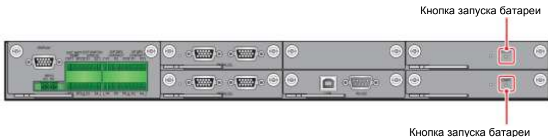
Рисунок 4-14: Расположение кнопок запуска батарей
