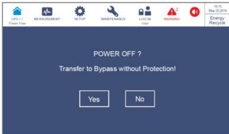
Рисунок 6-68: Экран с запросом об отключении
