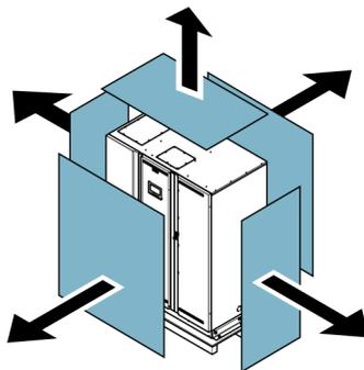
4. С обеих сторон вывинтите болты крепления транспортировочных скоб к шкафу и поддону.
