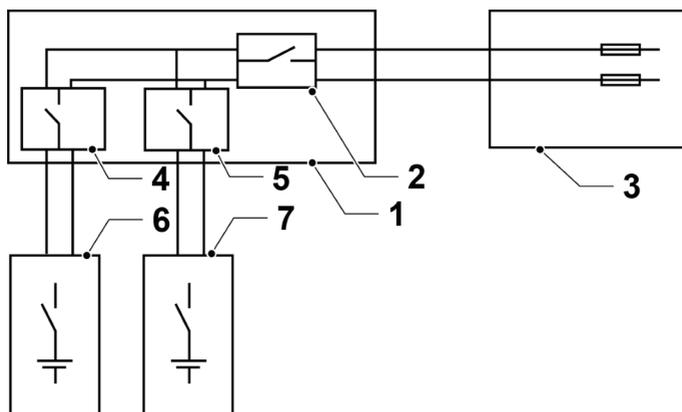
Рисунок 8. Схема подключения кабелей распределительных устройств внешних АКБ
