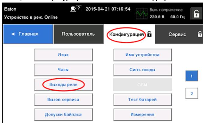
Рисунок 35. Выбор пункта Выходы реле в экране Конфигурация
