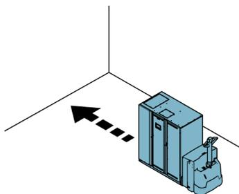
8. Чтобы зафиксировать шкаф ИБП в нужном положении, прикрепите транспортировочные скобы с обеих сторон шкафа уголками наружу. Рекомендуется крепить нижние крышки (входят в комплект) к кромкам корпуса.
