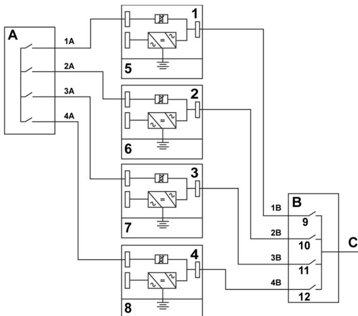
Рисунок 23. Принципиальная схема параллельного подключения систем ИБП
