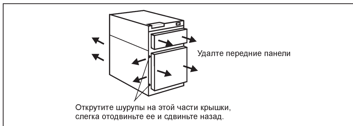
Рис.4а. Удаление передних панелей и открывание левой крышки с левой стороны.
