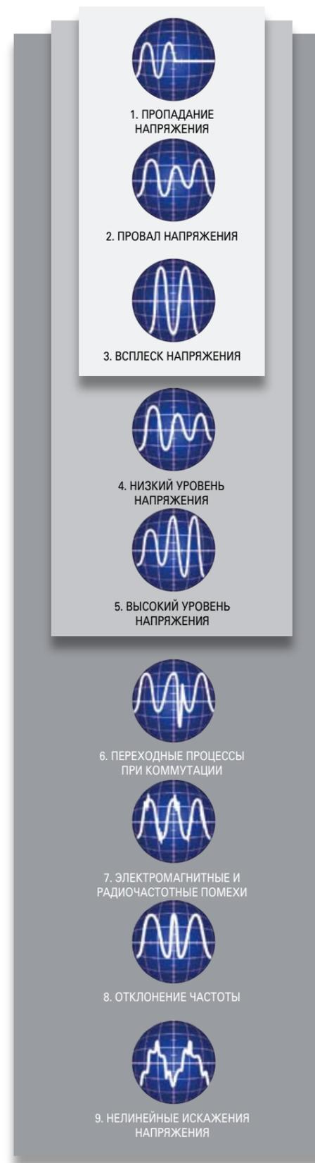
Существует 9 основных проблем с электропитанием (график слева). Концепция 3-5-9 подскажет, какие неполадки с электропитанием можно устранить с помощью того или иного оборудования Powerware. Она предельно проста и очень удобна при оценке потребностей в защите электропитания.
