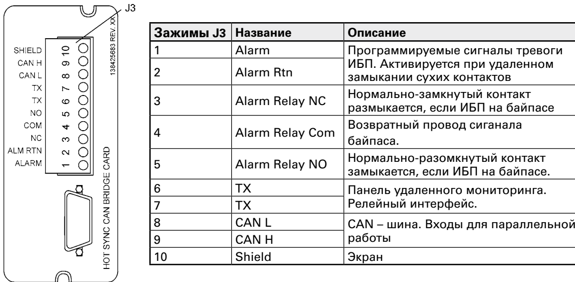
Рисунок 44. Плата XSlot Hot Sync и контактный интерфейс
